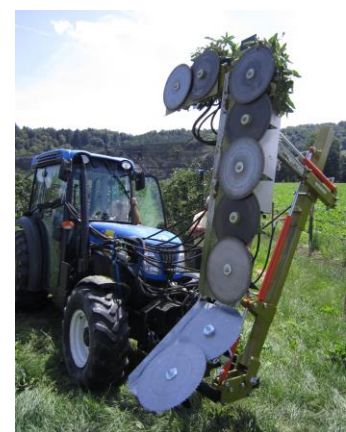
Schneidmaschine (oberen + unteren Balken)
