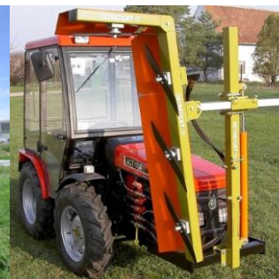
Schneidbalken (mit Kreissägeblätter oder Flügelmesser)
