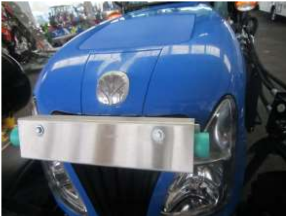
Abbildung 1: Ultraschallsensoren, Ansicht vorne
