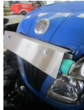
Abbildung 2: Ultraschallsensoren, Ansicht seitlich
