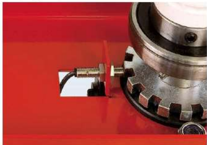
Berührungsloser Sensor für die Drehzahlabfrage, unempfindlich und verschleißfrei
