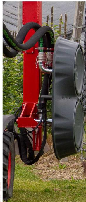
Der Hydraulik Komfortanschluß: Druckanschluß mit 45l/min und ein druckloser Rücklauf. Es sind keine zusätzlichen Steuergeräte erforderlich. Anschließen und los geht's! Ein ergonomisch geformter Rotorkopf verhindert Beschädigungen oder Abfallen der Früchte.
